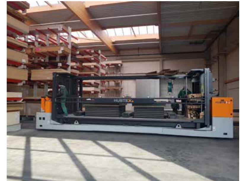
Materialschonende Technik: Mit der neuen Hubtex Kommissionierplattform wird die Ware einfach aus dem Regal herausgehoben
