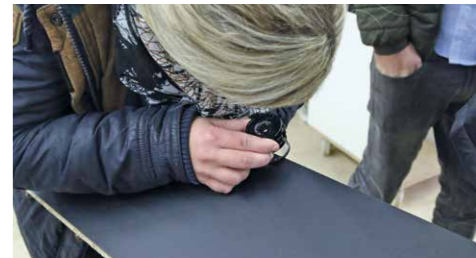
Business Development Managerin Bettina Melber nimmt die Platte unter die Lupe und untersucht die Kante auf sogenannte „Mäusezähne“.
