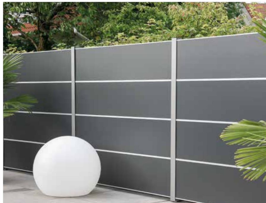
Pfosten 7 x 7 x 180 cm pulverbeschichtet, steingrau und anthrazit, Anfangs-/Endpfosten, Mittelpfosten, Eckpfosten, Pfostenanker verzinkt zum Einbetonieren und Aufdübeln.
