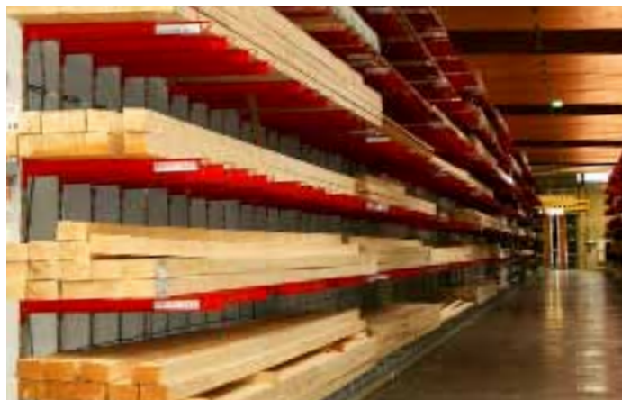
Die Lagerung der längeren Hölzer erfolgt im Werk von Carl Götz mit Kragarmregalen von Ohra
